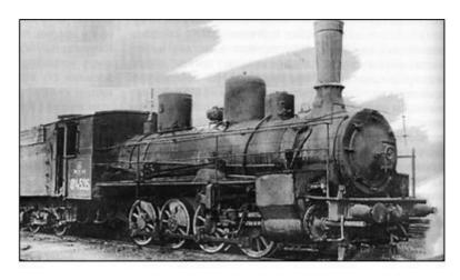
Алтайская железная дорога оснащалась паровозами серии Ов (верхний снимок) и серии «Ы» (нижний снимок). Последние Коломенский машиностроительный завод в 1913-1915 гг. специально выпускал для Алтайской «чугунки» под индексом «Ыу».
